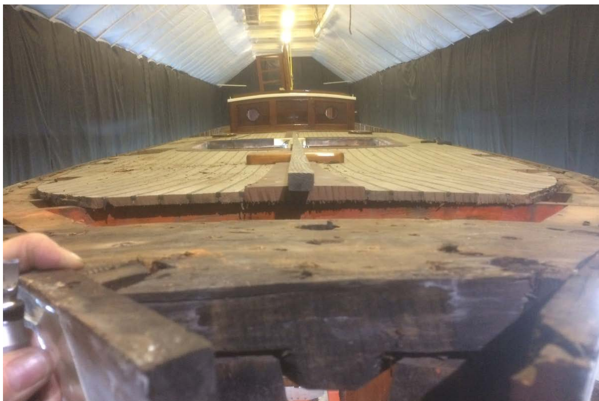
Fördäcket i stort behov av renovering. Teakdäcket var endast tolv millimeter tjockt och spikarna synliga på många ställen. Det saknar helt balkbukt och med helt nya balkar kommer det att höjas 80 millimeter. (Foto: Tony Duda)
